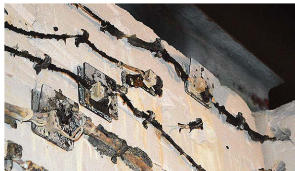
Рис. 2. Кабельные линии до и после испытания.
